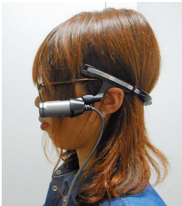
図8. 注視方向計測カメラ
