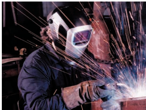
写真3-3 呼吸ができる溶接マスク speedglass9000
