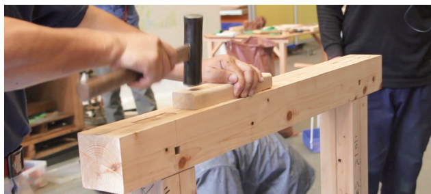
写真19 大工作業台組み立て
