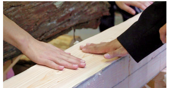
写真31 仕上げ肌の確認
