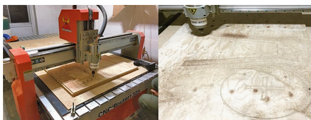
図6 大型CNCを使用した展示什器加工の様子
