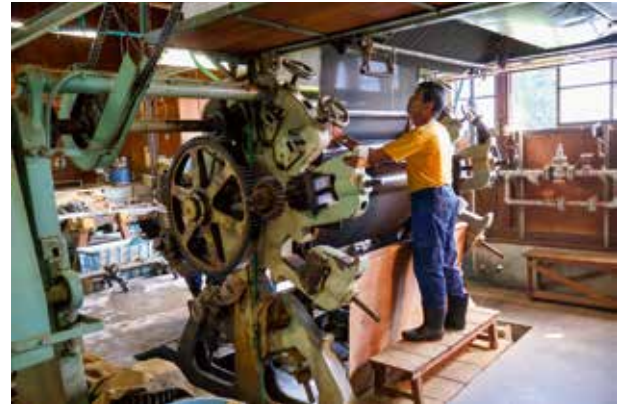
8-3-2 銅製のローラーと布の接地面積の距離や感覚は熟練の職人による作業
