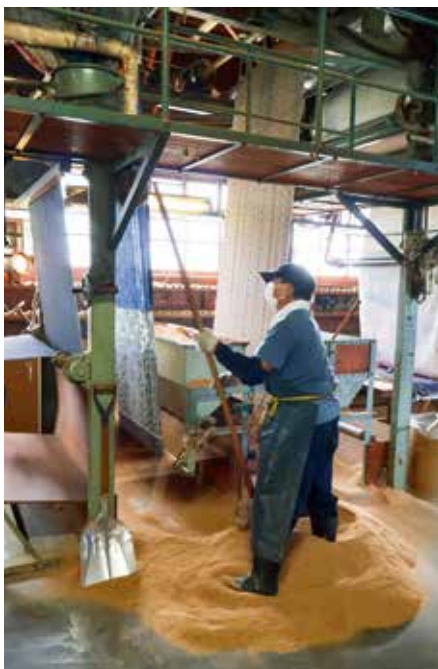
8-3-5 布にまぶしたおがくずによって、布の間に空気が入り、その空気によって糸の色の変化が進み、布の移染も防ぐ効果もある。
