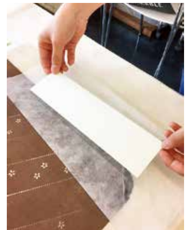
5-11 修復した部分に不織布と吸い取り紙を当て乾燥させる
