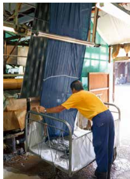
8-3-8 乾燥させたのち、亜硫酸ソーダ液に浸す。捺染した部分のみが残り、ほかは脱色する。
