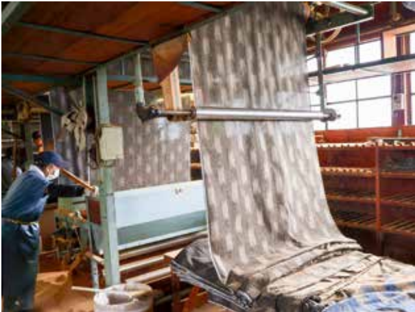
8-3-6 おがくずがついた状態だが柄ははっきりと浮き出ている。中段についた棒状のローラーが振り子のように動き、布が折り重なり蛇腹状に折りたたまれる。
