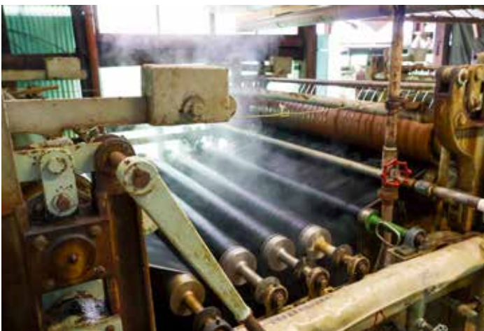
8-3-8 乾燥させたのち、亜硫酸ソーダ液に浸す。捺染した部分のみが残り、ほかは脱色する。
