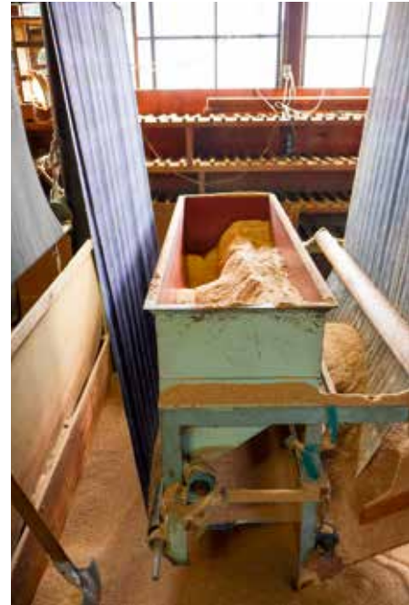
8-3-4 中和剤で化学反応を起こした布の色が徐々に変わっていくが、早い段階で布におがくずをまぶす。
