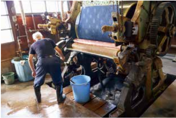
8-3-1 銅製の柄が彫られたロールに塩化アニリン糊を用いて型置き、捺染する。
