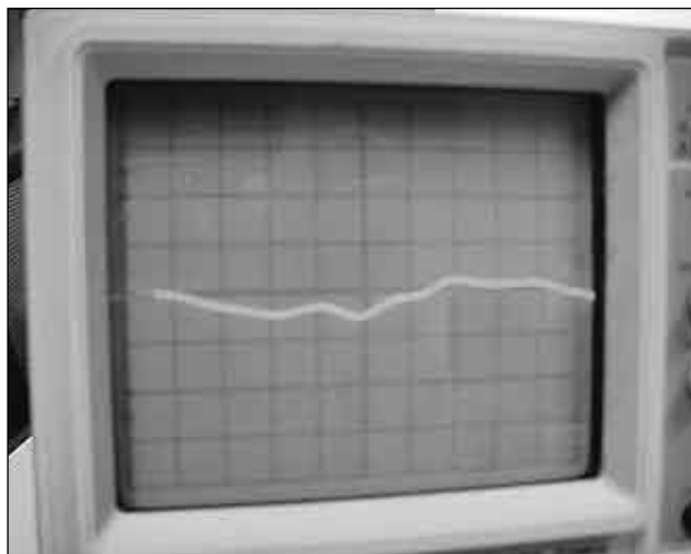
図 5 純銀円盤電極の出力信号例：脱力(上) 力を入れる(下)
